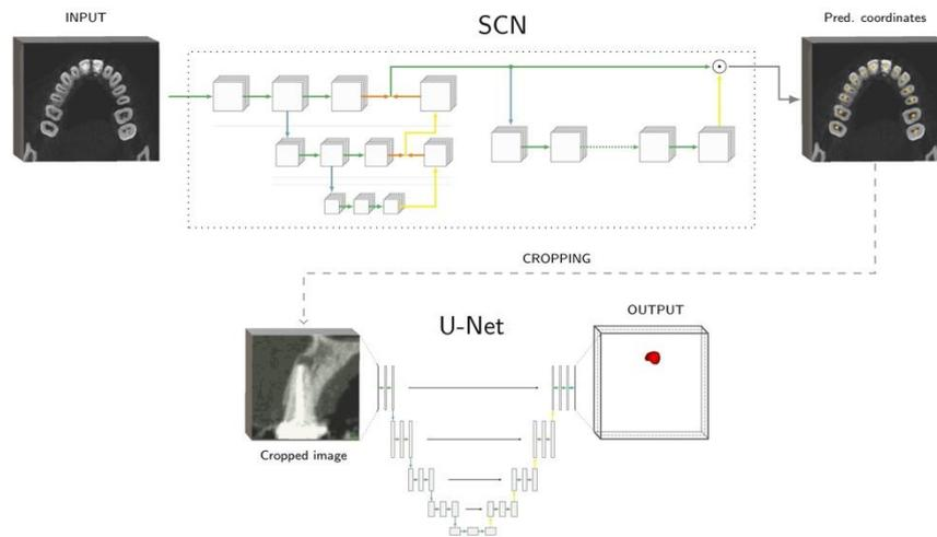
Abbildung 1: Schematische Darstellung der beiden hintereinandergeschalteten Netzwerke (SCN und U-Net) erstens zur Zahnerkennung und zweitens zur Läsionserkennung unter Erhalt der hohen Auflösungskapazität der DVT-Datensätze.
